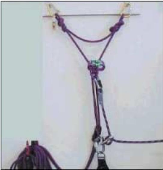
Kontrollieren ob die beiden Seilstränge getrennt befestigt sind!
