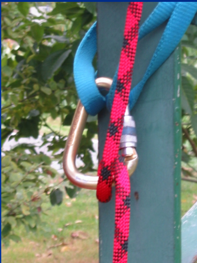
Nesprávné vložení lana do bodu postupového jištění
